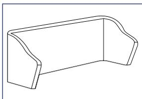
Protezione valvola **V2**. Adatta a ruote da 30" di diametro e superiori. Presente soprattutto su cerchi per uso agricolo. Questo tipo di protezione valvola è necessario quando si utilizza il montaggio gemellato Sävsjö.
